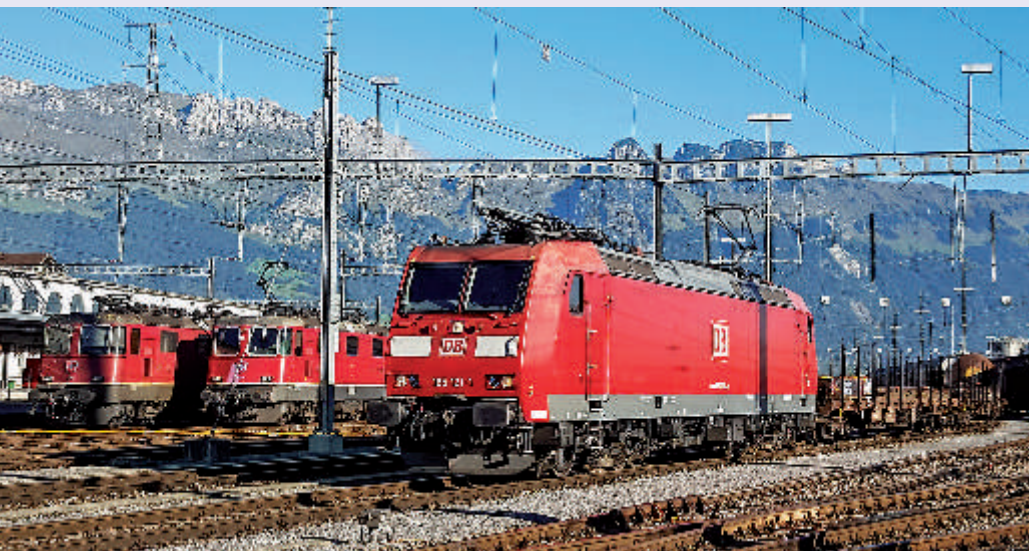
Moderne E-Loks mit ETCS für grenzüberschreitende Einsätze, wie hier 185 121 der DB, versinnbildlichen den hinter dem europäischen Eisenbahnraum stehenden Gedanken der Interoperabilität. Die Migration neuer Techniken verläuft allerdings nicht immer reibungslos, wie die aktuellen Probleme der DB-Baureihe 185 beim Einsatz in der Schweiz zeigen (siehe dazu auch S. 25). Ebenjene 185 121 wartete am 21.09.15 im Grenzbahnhof Buchs SG mit dem Zug 45708 aus dem österreichischen Hall in Tirol auf die Abfahrt zum Rangierbahnhof Limmattal bei Zürich. Foto: Remo Hardegger
